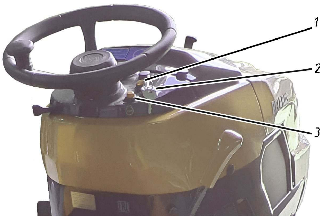
Рисунок 3.2 – Панель управления 1 – кнопка запуска косы; 2 – ключ зажигания; 3 – кнопка останова двигателя
