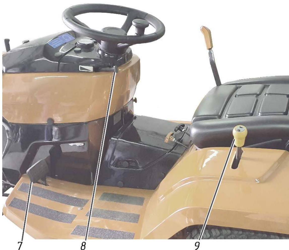
Рисунок 3.16 – Расположение органов управления газонокосилки 7 – педаль управления тормозом; 8 – рычаг управления подачей топлива; 9 – рычаг переключения передач
